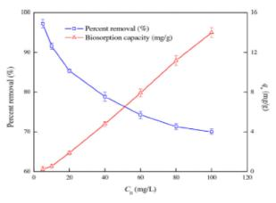
Gambar 7. Pengaruh konsentrasi awal Zn(II) pada biosorpsi Zn(II) ke CPH (CPH dosis 0,5 g/100 mL: kecepatan pengadukan 150 rpm; suhu 30 °C; pH 6) (Njoku, 2014)
